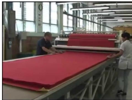
Figura 3. Tendido de tela
