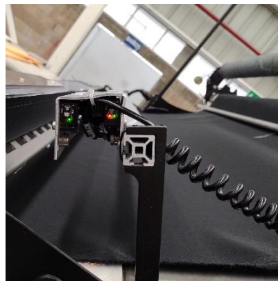
Figura 49. Pruebas con sensores retroreflectivos (detección de tela).
